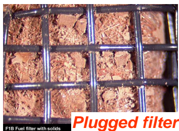
Slika 13: Začepljenje filtra uzrokovano sulfatima
