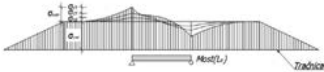
Slika 22. Ukupna naprezanja od DTT-a bez naprave
