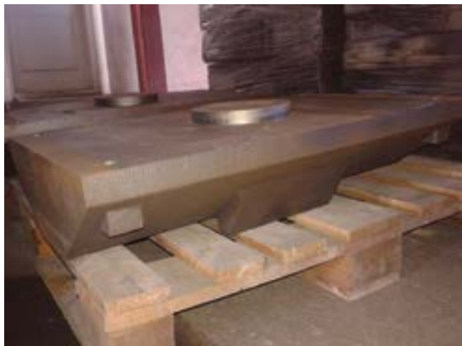
Slika 4. Nova gornja ploča nepokretnog ležaja stupa S3
