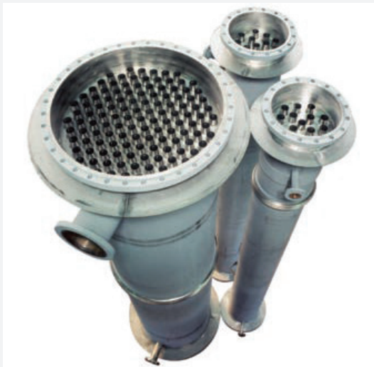
Slika 3 – Sulzerovi isparivači Chemtech s padajućim i tankim filmom (eng. falling and thin film evaporators ) često se upotrebljavaju u organskoj kemijskoj industriji kao kolonski rebojleri u vakuumskim destilacijskim sustavima (izvor: http://www.sulzer.com )
