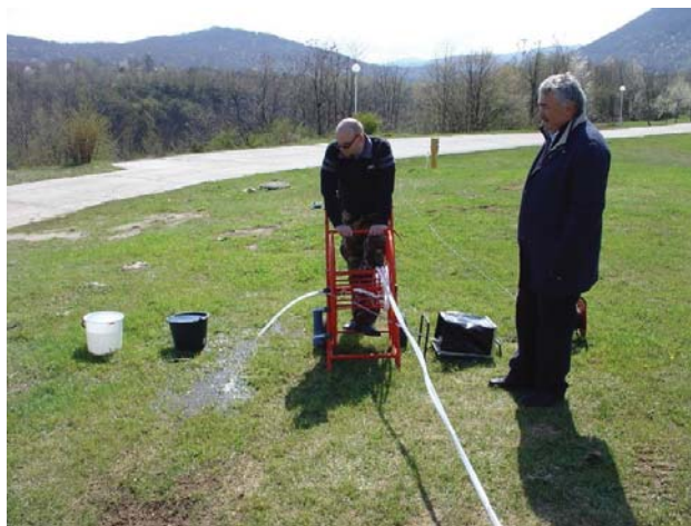
Slika 5. Probno crpljenje piezometra PJ-2, Autokamp Korana, (travanj 2008.)
