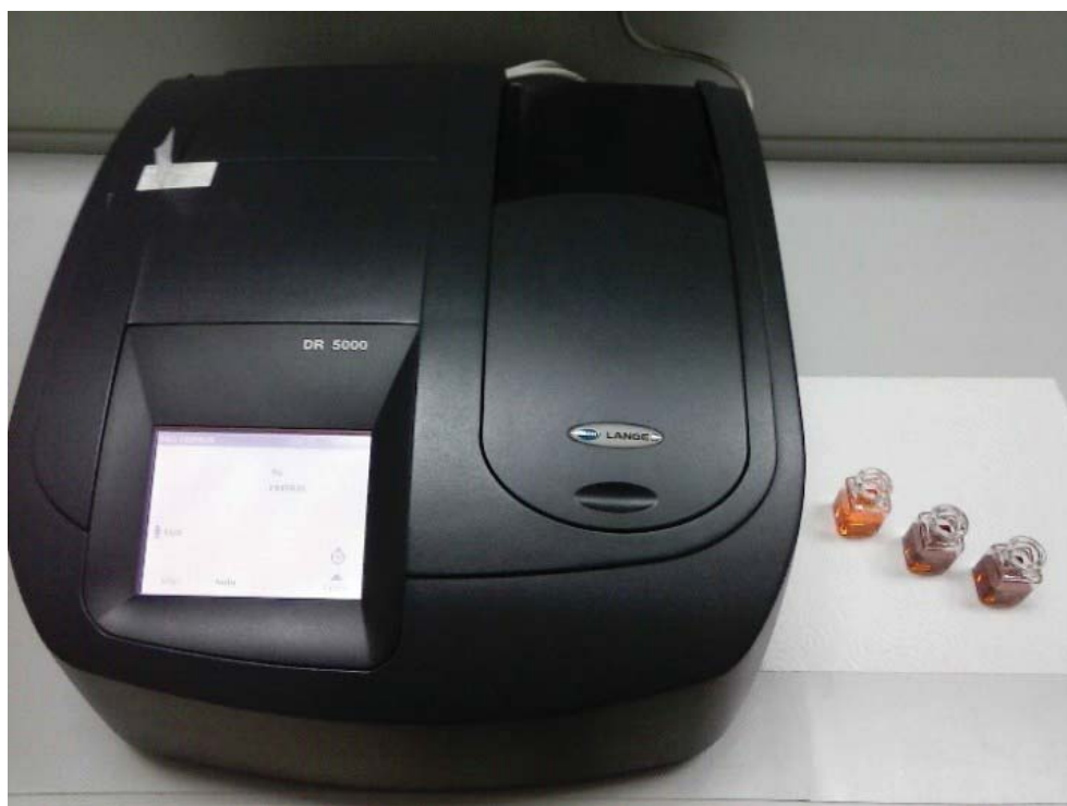
Slika 3. Spektrofotometar HACH DR5000, određivanje humusa
