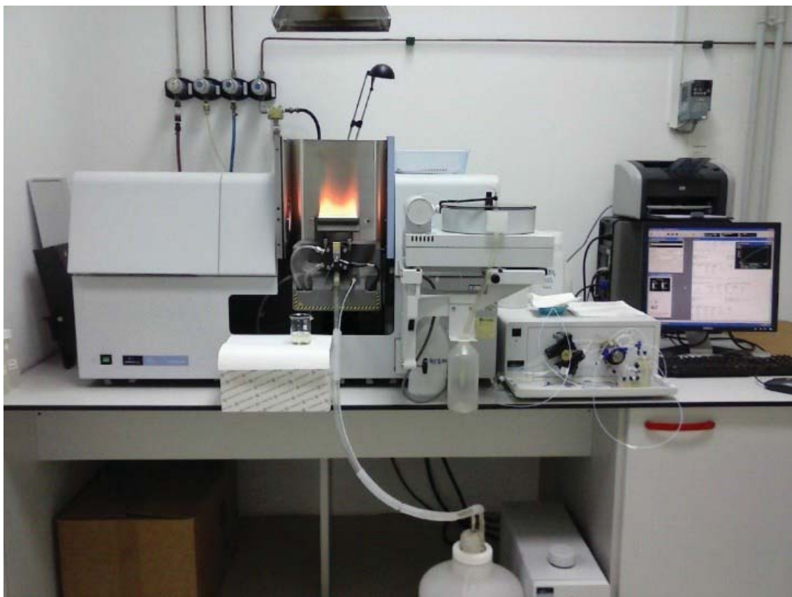
Slika 1. Atomski apsorpcijski spektrometar Perkin Elmer AAnalyst 800, FAES tehnika, analiza kalija
