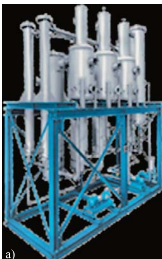
Sl.13 Sustav tvrtke Körting: a) za rekuperaciju lužine Körting CRP, b) shematski prikaz postupka mercerizacije sustava Körting CRP
