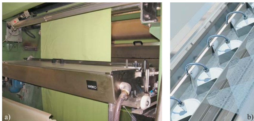
Sl.9 Tvrtka Weitmann & Konrad predstavila je: a) WFA sustav s b) beskontaktnim rotorskim sustavom za doziranje nanosa kupelji
