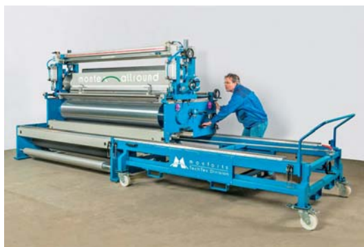
Sl.6 Montex-Allround modularna jedinica za naslojavanja tvrtke Monforts s fiksnom donjom i modularnom gornjom sekcijom – mogućnost brze promjene prema zahtjevima tržišta
