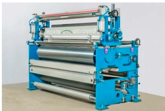
Sl.6 Montex-Allround modularna jedinica za naslojavanja tvrtke Monforts s fiksnom donjom i modularnom gornjom sekcijom – mogućnost brze promjene prema zahtjevima tržišta
