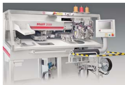
Sl.1 Pfaff 3589 automata za našivanje džepova na džinsu, bluzama i košuljama, radnoj odjeći i sličnim proizvodima
