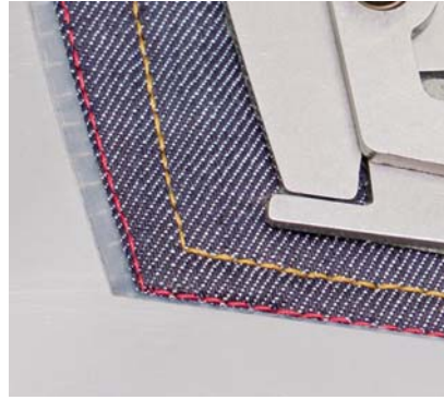
Sl.2 Pfaff 3589 s jednostavno izmjenjivim oblicima i šablonama, povećane šivače glave i hvatala
