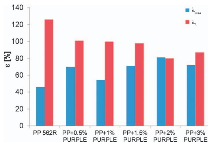
Sl.3 Ovisnost prekidnog istezanja PP vlakna i PP vlakana s različitim udjelom pigmenta (PURPLE) dobivenih uz omjere istezanja \lambda_3 i \lambda_{max}
