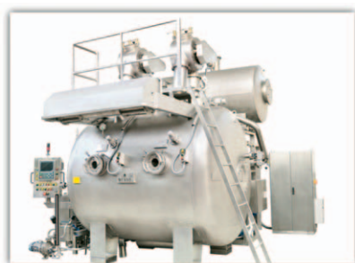
Sl.2 Prikaz NUVAS stroja, kapaciteta 500/600 kg (strojevi su izgrađeni od dviju komora koje rade zajedno)
