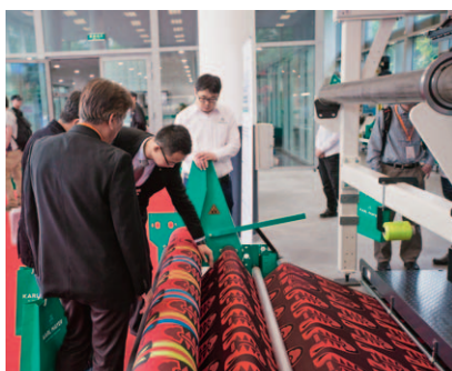
Sl.1 Osnovoprepletaći stroj RDJ 5/1 tvrtke KARL MAYER za izradu višebojnog materijala za tenisice
