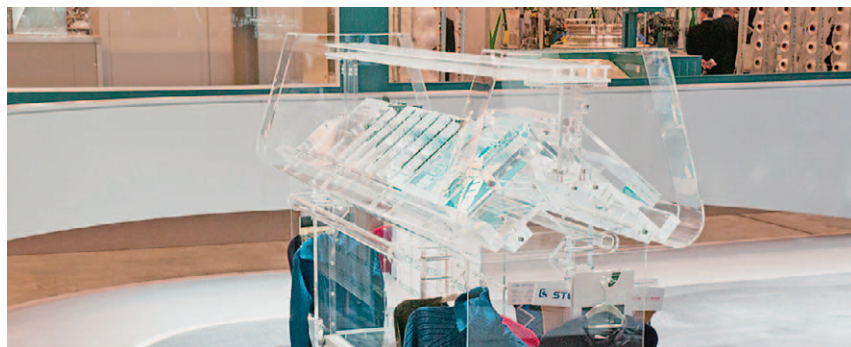
Sl.2 „Transparentni“ stroj za ravno pletenje sa sutavom igala tvrtke Groz-Beckert
