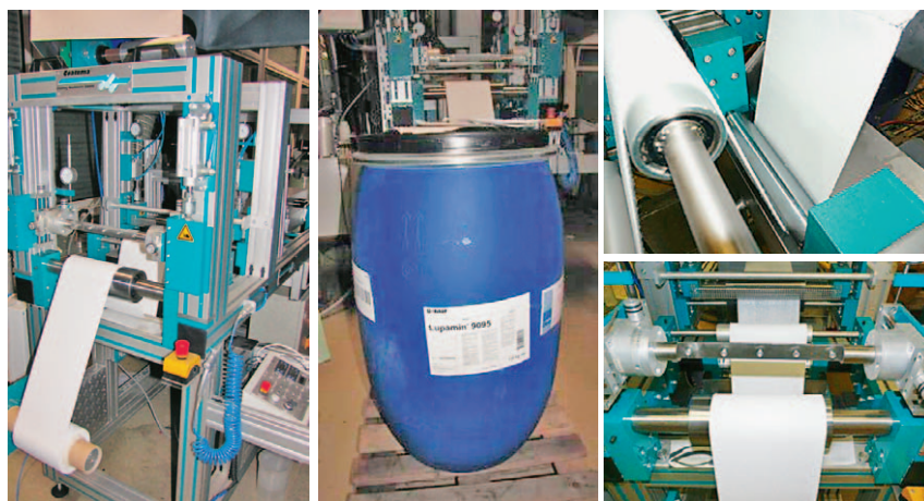
Sl.1 Fotografije poluindustrijskog uređaja za naslojavanje koji je korišten za kontinuirano učvršćivanje tehničkog polivinilamina
