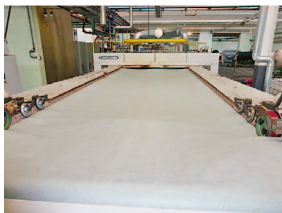
Sl.6 Obrada, odnosno naslojavanje poliestera polivinilaminom u industrijskim uvjetima
