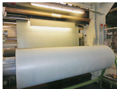
Sl.6 Obrada, odnosno naslojavanje poliestera polivinilaminom u industrijskim uvjetima
