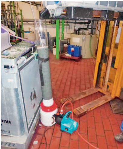
Sl.8 Pogonsko proizvodno ispitivanje za uporabu paladija iz industrijske procesne vode korištenjem PET netkanog tekstila modificiranog PVAm-om
