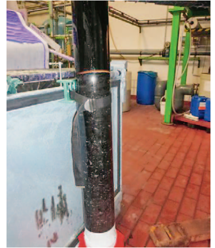
Sl.8 Pogonsko proizvodno ispitivanje za uporabu paladija iz industrijske procesne vode korištenjem PET netkanog tekstila modificiranog PVAm-om
