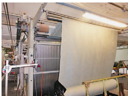
Sl.6 Obrada, odnosno naslojavanje poliestera polivinilaminom u industrijskim uvjetima
