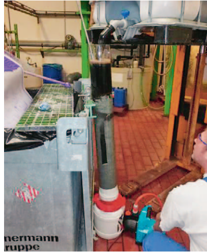
Sl.8 Pogonsko proizvodno ispitivanje za uporabu paladija iz industrijske procesne vode korištenjem PET netkanog tekstila modificiranog PVAm-om
