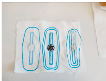
Sl.1 Primjeri 3D tiskanih elektroničkih sklopova
