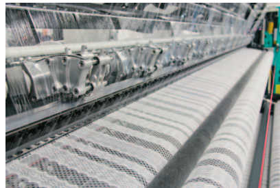
Sl.1 Pletivo čipkastog izgleda izrađeno na stroju HKS 4-M EL tvrtke Karl Mayer
