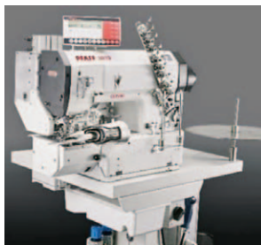
Sl.1 Stroj PFAFF 3819 s radnom operacijom za prišivanje pojasa na džins hlačama
