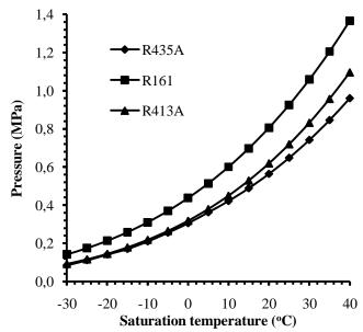
**Figure 3.** Saturation vapour pressure curves **Slika 3.** Krivulje tlaka zasićene pare
