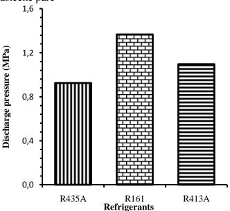
**Figure 4.** Discharge pressure at condensing temperature of 40 °C **Slika 4.** Izlazni tlak pri temperaturi kondenzacije od 40 °C
