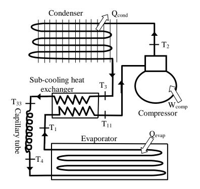
**Figure 1.** Refrigeration system with a sub-cooling heat exchanger **Slika 1.** Rashladni sustav s pothlađenim izmjenjivačem topline
