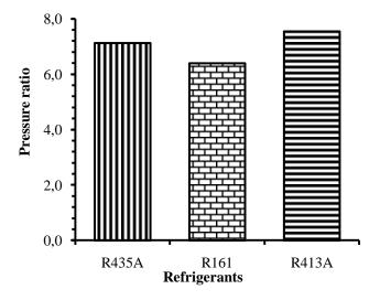
**Figure 5.** Pressure ratio at condensing temperature of 40 °C **Slika 5.** Omjer tlaka pri temperaturi kondenzacije od 40 °C
