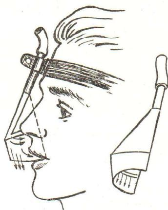
učvršćen je na čelu, kapi ili naočarima. Respirator može biti izrađen iz stakla, plastike ili lima. Svjež zrak, koji struji poput zračne zavjese, može se dobiti iz rezervoara za komprimirani zrak ili crpsti iz slobodne atmosfere preko cijevi pomoću ventilatora. Zrak treba da struji u količini od 30–50 l/min. brzinom od 1–2 m/sek.
