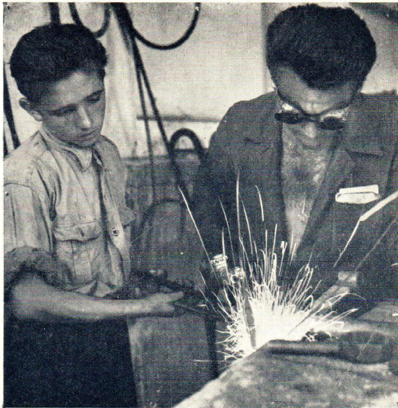
Slika 4. Kod svarivanja prskaju užarene iskre Učenik u privredi, koji pomaže kod rada, nema zaštitne naočari
