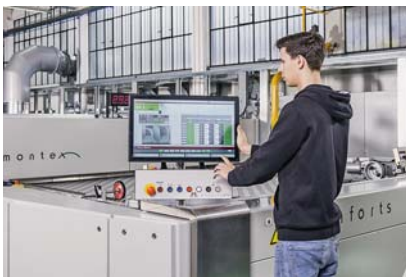
Sl.1 Novi sustav za upravljanje strojeva za oplemenjivanje Qualitex 800 tvrtke Monforts
