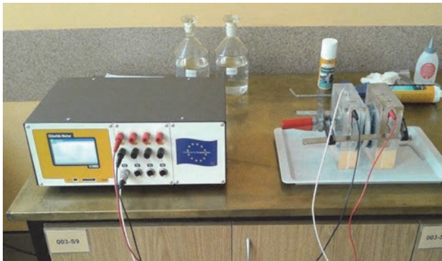
Slika 4. Mjerenje elektropropusnosti betona
