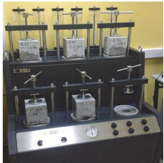
Slika 6. Ispitivanje prodora vode pod tlakom
