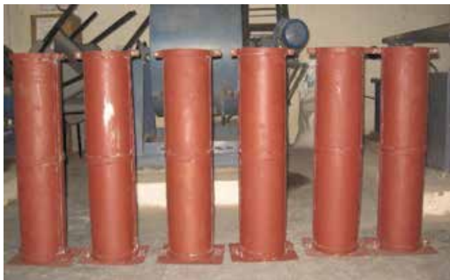
Slika 6. Kalupi za kružne stupove
