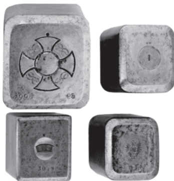
Slika 36. Set od četiri komada čeličnih kalupa za kovanje poluminijature Ordена talijanske krune
