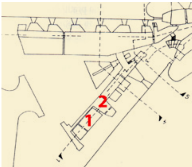
7. Tlocrt tvrđave sv. Nikole s označenom barutanom na donjoj etaži: 1 – barutana, 2 – zazidani topovski otvor (izvor: JOSIP ČUZELA /bilj. 23/, 1992., 58)
