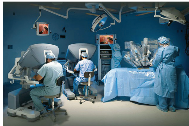
Slika 25 Robotski sustav „da Vinci“ s dvije konzole (jedna je za učenje), četiri „ruke“ robota, te ekran sa slikom operacije [43]
