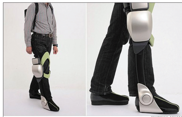
Slika 10 Proteza koja omogućava hod s paraliziranom nogom [12]
