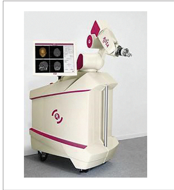
Slika 29 Neurokirurški robotski sustav „ROSA“ [20]
