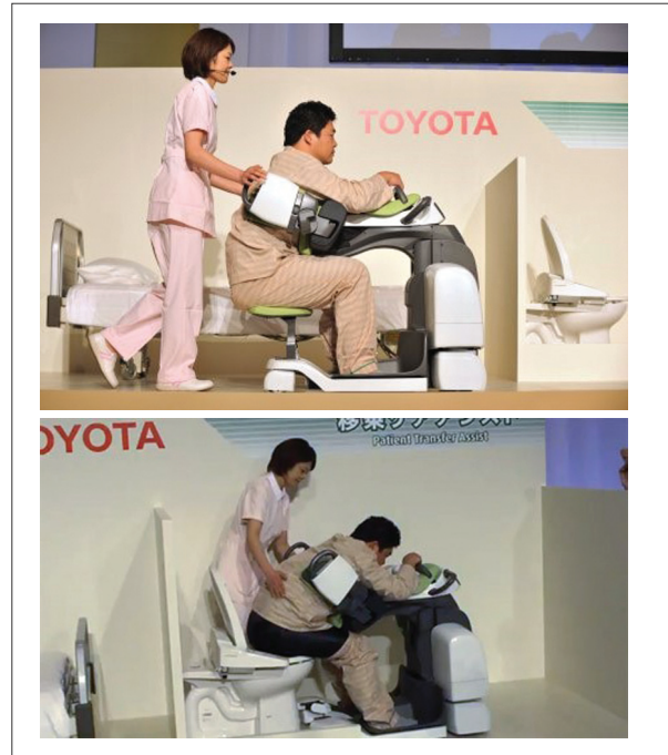
Slika 9 Toyotin robot u bolnicama ili kod kuće za prijenos nepokretnih i teških bolesnika [10]
