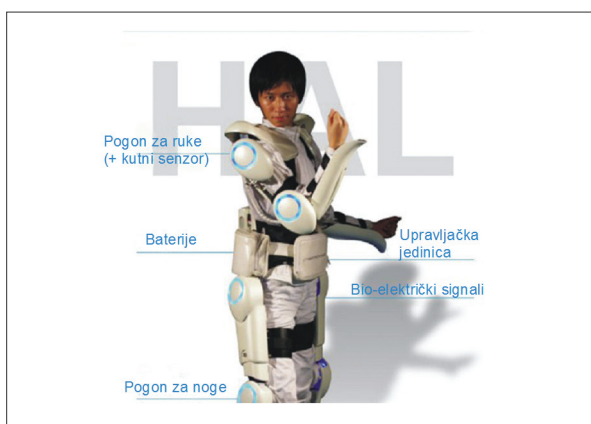
Slika 7 Japanski ekzoskelet HAL namijenjen pomoći bolesnicima kod raznih bolesti mišićne motorike [4]
