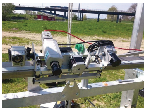
Slika 3 Senzori instalirani na mehaničkom klizaču dužine 4m.
