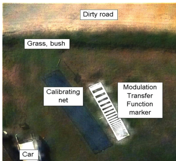
Slika 5 Hiperspektralni snimak iz testnog, minskog poligona Cerovac snimljenog s BZ u srpnju 2015. godine.
