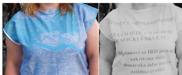
Slika 4 V vizualni prikaz odjavnog predmeta sa kartografskim motivom i NIR prikaz istog tekstila u infracrvenom spektru
