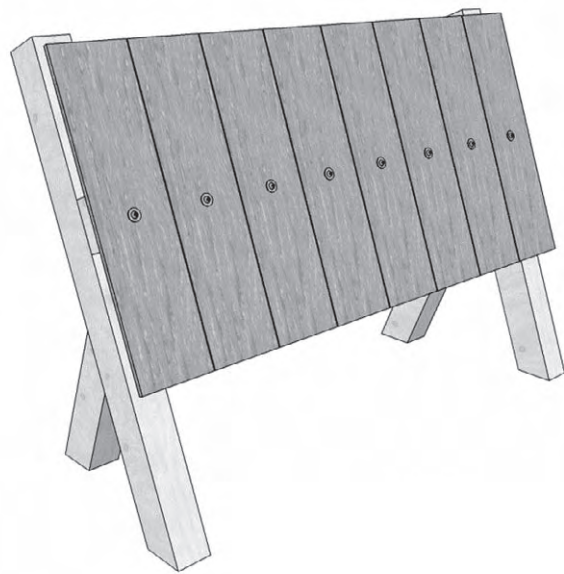
Figure 3 Rig for the salt spray test with mounted specimens Slika 3. Sustav za ispitivanje utjecaja raspršene slane otopine na drvene premaze
