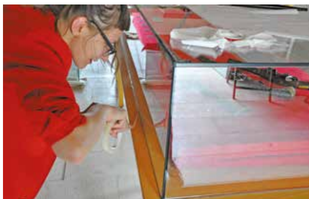
15 Brtvljenje spoja staklenoga zvona i gornje plohe stola ljepljivom vrpcom 3M™ Type 850 (foto: S. M. Sunara, svibanj 2015.)
