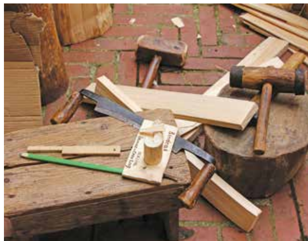
5 Pomagala za izradu pokrova od ražene slame: daska s nazubljenim naličjem služi za poravnavanje donjeg ruba snopića, naprava u obliku dvostrukog križa kojom se pritišću snopići, škare za obrezivanje suvišnih vlati nakon završenoga prekrivanja. (foto: G. Jerabek)
