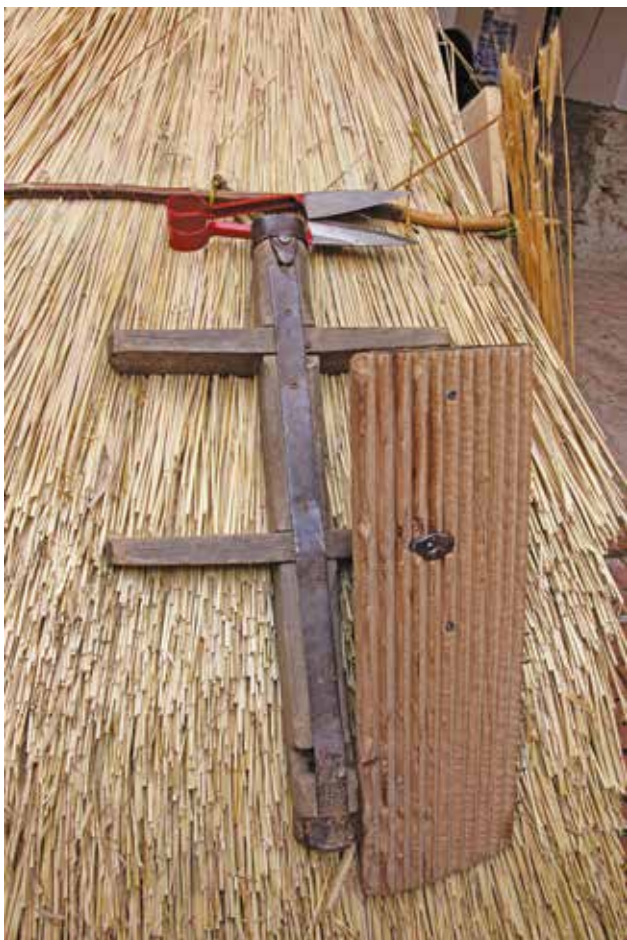
4 Pomagala za proizvodnju šindre: stolarska olovka za obilježavanje, „mjerica“ kojom se određuje širina šindre, „batić“ – drveni čekić i „bat“ – drveni čekić ojačan metalnim prstenovima za udaranje po sjekiri kojom se cijepa komad debla u šindru. Vidljiv je i suvenir pripremljen u obitelji Štimac za sudionike radionice. (foto: G. Jerabek)
