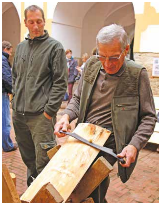
1 Prezentacija skidanja „makljom“ ili „rezivnikom“ suvišne biljne mase. Anton Štimac i sin Borivoj, nastavljajući tradiciju izrade i pokrivanja krovništva šindrom u Gorskom kotaru. (foto: G. Jerabek)
