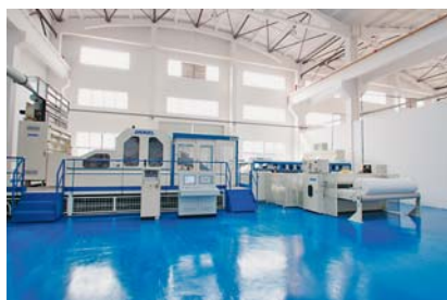
Sl.2 neXline pilot postrojenje za proizvodnju netkanog tekstila u novom tehničkom centru za netkani tekstil (foto ANDRITZ)
