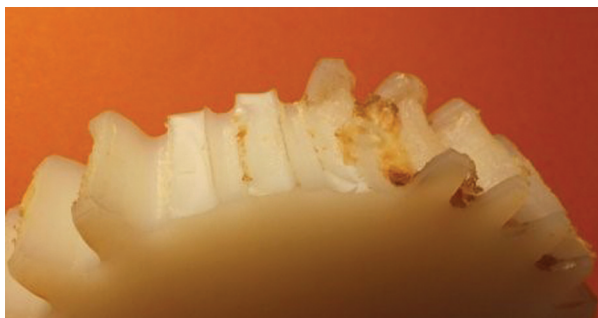
Slika 2 Toplinsko zaribavanje poliamidnog zupčanika s lomovima u korijenu zuba
