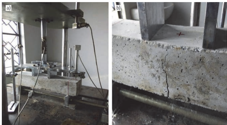
Slika 5. Ispitivanje uzoraka: a) Postav za ispitivanje zamora, b) Lom uzorka
