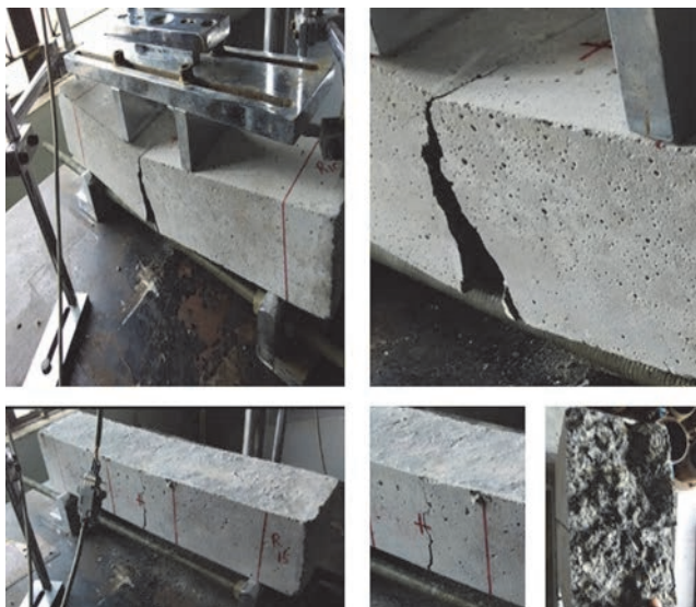
Slika 7. Popuštanje uzoraka tijekom ispitivanja zamora
