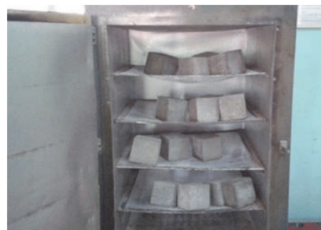
Slika 2. Betonske kocke u pećnici
