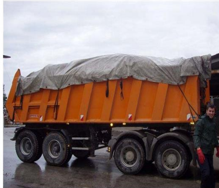
Slika 3 Prijevoz azbestnog otpada na odlagalište u posebnom vozilu
