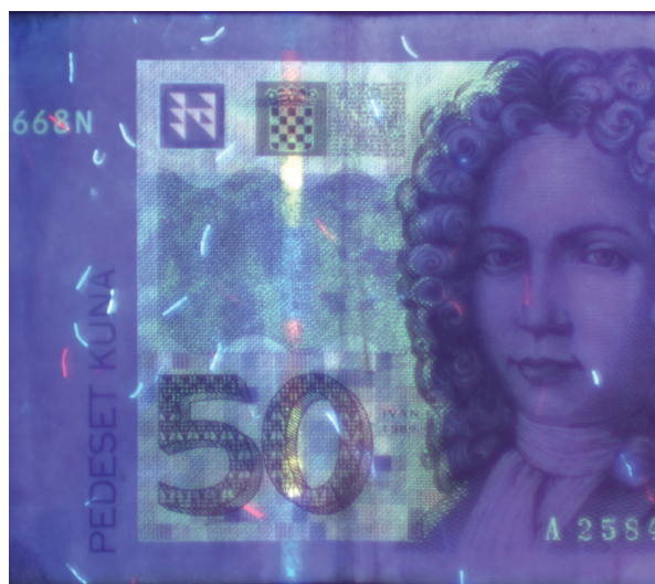
Slika 1. Segment s lica novčanice nominalne vrijednosti 50 kn, u spektralnom području od 365 nm
