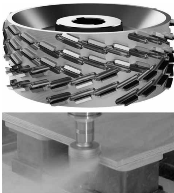
Slika 1. Inovacija kod Leuco p-System alata za obradu drva (izvor: www.leuco.com )
