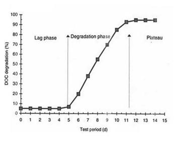
Fig. 7 – Degradation curve<sup>28</sup>
