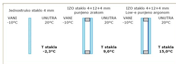
Slika 2. Temperature na unutarnjoj strani stakla ovisno o vrsti ostakljenja
