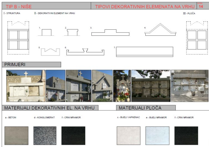
Slika 6. Analiza tipova dekorativnih elemenata. Primjer – gornji dio niša [1]
