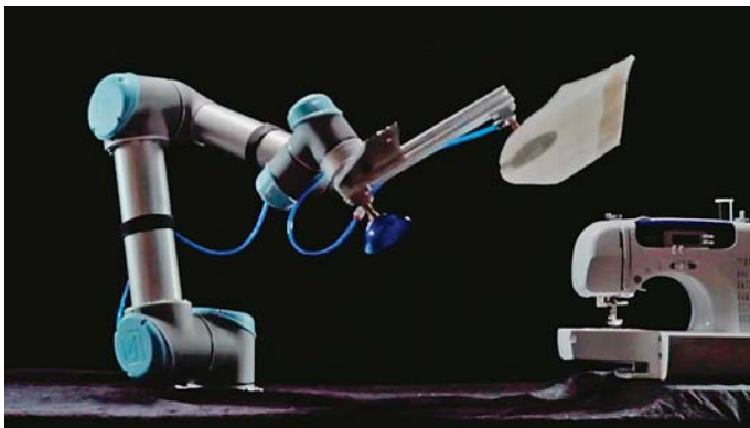
Sl.7 Robot Sewbot (UR) prostorno prenosi skrućeni krojni dio [25]
