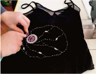
Sl.16 Ušivanje LilyPad komponenti na odjevni predmet
