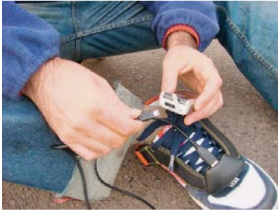
Sl.1 Prototip tenisice s punjačem za mobitel [3]
