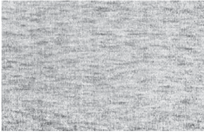
Sl.3 Uzorak A tkanine izrađene od pređe kvalitete USP 50 % prema Uster standardu iz 1964. godine
