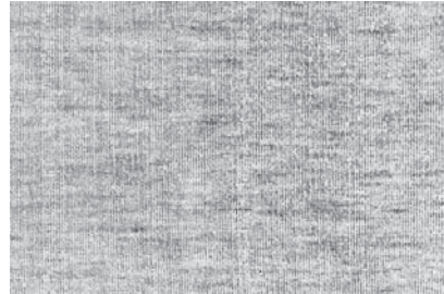
Sl.4 Uzorak B tkanine izrađena od pređe kvalitete USP 50% prema Uster standardu iz 2013. godine
