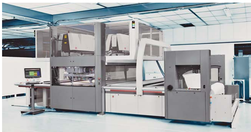
Sl.1 Stroj za iskrojavanje zračnih jastuka od tkanina otkanih u jednom komadu FocusQuantum® OPW 3K tvrtke Lectra
