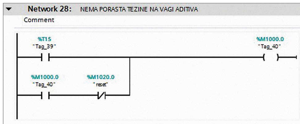
Slika 5.6 Pojava alarma na alarmnoj listi i njegov reset alarma
