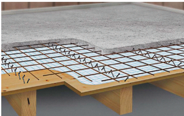
Slika 1 Prikaz spregnute konstrukcije
