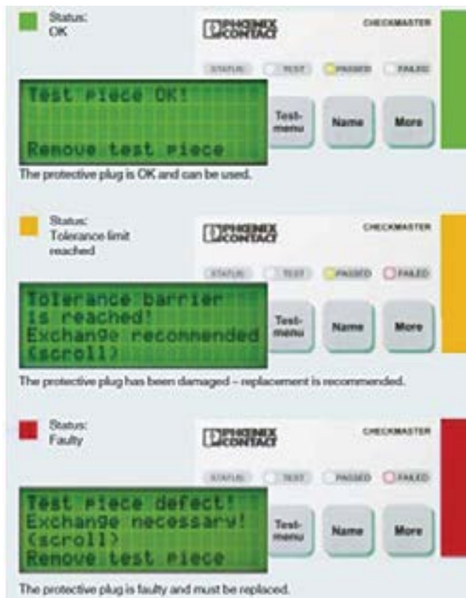
Slika 14. Primjer izvješća nakon ispitivanja prenaponske zaštite
