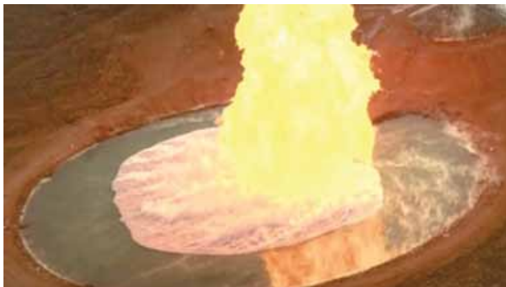
Slika 2. Požar lokve LNG-a
