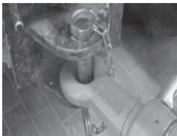
Fig. 1 Tractor coupling »fork« system
