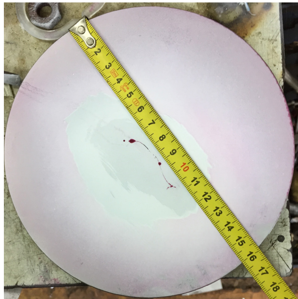
Slika 6 Presjek vagonске osovine promjera 160 mm ispitane penetrantskom metodom.
