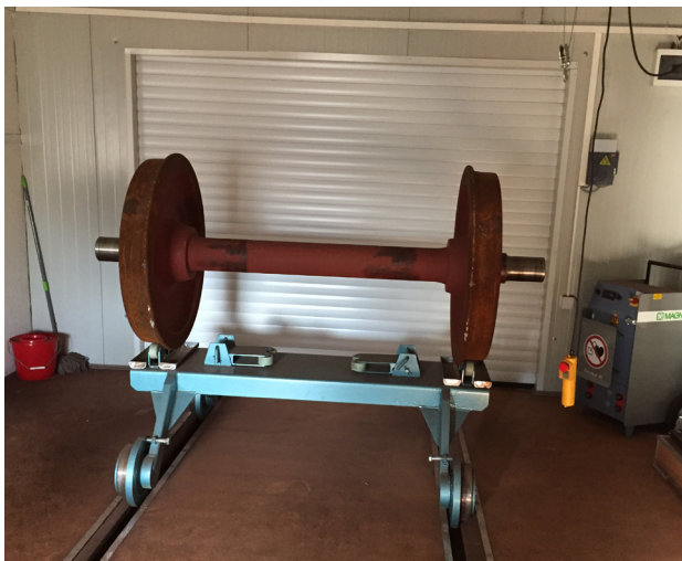
Slika 5 Vagonska osovina pripremljena za ultrazvučno ispitivanje
