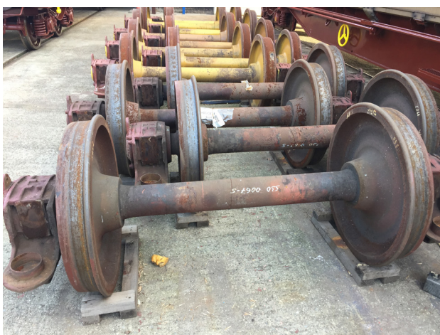
Slika 1 Pripriježene vagonске osovine za ultrazvučno ispitivanje
