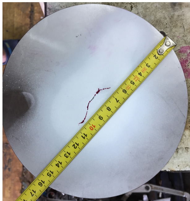
Slika 7 Presjek vagonске osovine promjera 160 mm ispitane penetrantskom metodom.
