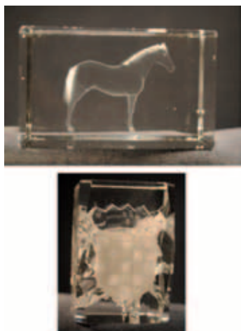
Slika 4. Rezultat graviranja za premalen razmak između točkica- ispucani dijelovi kristala
