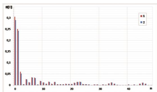
Slika 4. Frekvencijski sastav raspodjele magnetske indukcije na polnom koraku: 1 – za pol broj 2; 2 – za pol broj 4.
