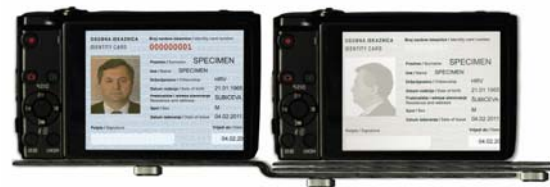
Slika 4. Prototip osobne iskaznice s ugrađenim dualnim portretom prikazan preko ZRGB kamere za dualno gledanje
